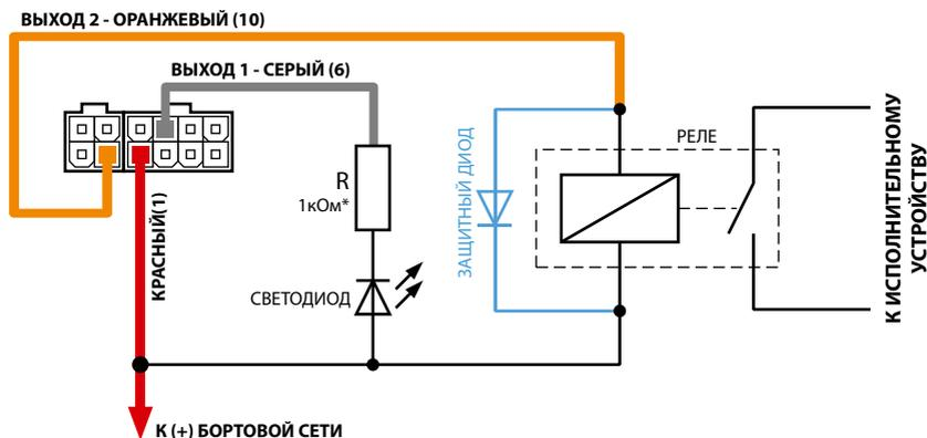
\* Для напряжения питания бортовой сети 24 В:  $R = 1 \dots 2 \text{ кОм}$ .
