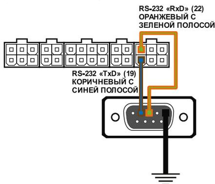
В настоящее время контроллер АвтоГРАФ-GSM поддерживает работу со следующими устройствами по интерфейсу RS-232:
